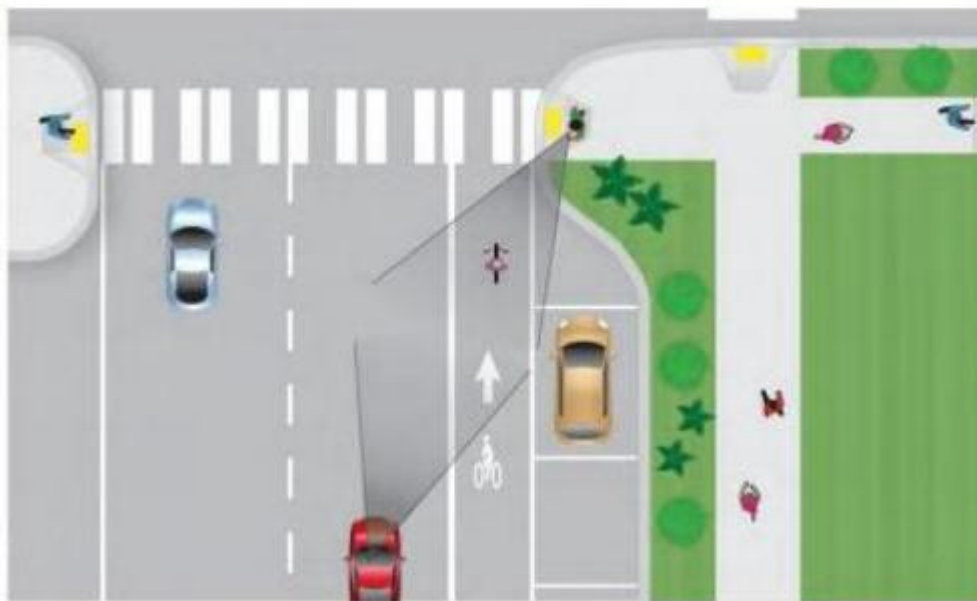
Figura 8: Avanzamento del marciapiede
